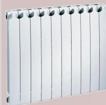
Les radiateurs en aluminium sont les radiateurs les plus légers. Ils ont l'avantage d'être les radiateurs les plus rapides à chauffer sans pour autant refroidir très rapidement. Ce sont les radiateurs les moins chers. Ils ont comme principal inconvénient de ne pas pouvoir être installés sur un circuit comprenant d'autres types de radiateur, car l'aluminium n'est pas compatible avec la fonte et l'acier.
